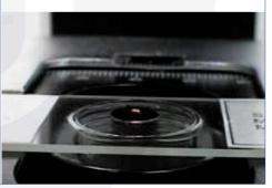
2. Mover el condensador a la posición más alta y coloque una gota de aceite de inmersión en la lente
